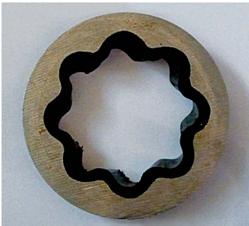
Рис. 1. Поперечное сечение статора двигателя ДШОТР-106.7/8П.30
